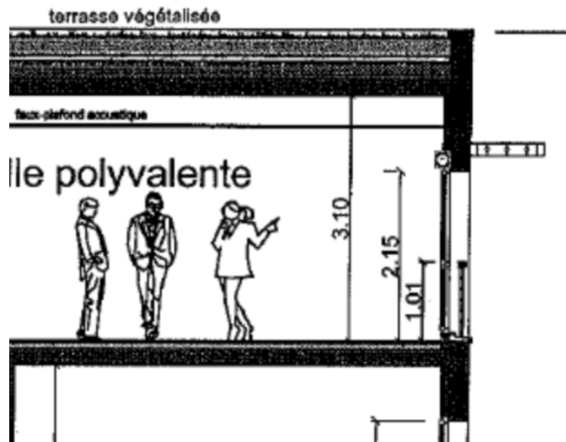
Détail toiture intensive
