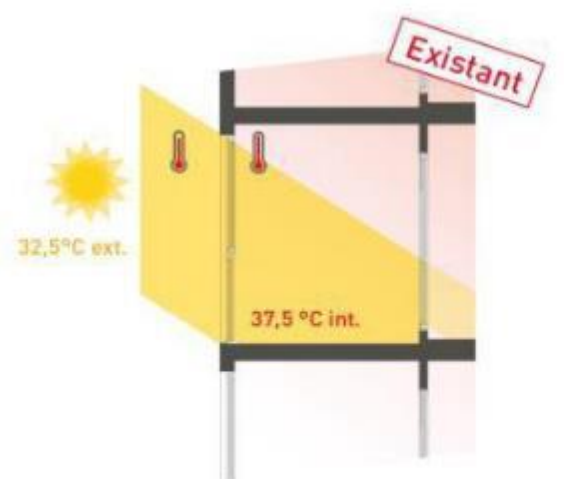
Grand châssis des loggias en façades Est / Ouest Surchauffe très importante en été à l'Ouest
