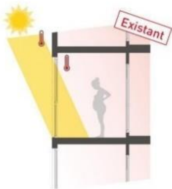
Châssis des loggias en façade Sud Surchauffe en été
