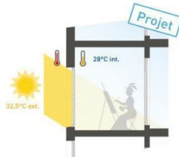
Vitrage à protection solaire sur les petits châssis de 284 loggias en facades Est / Ouest Surchauffe maîtrisée + Entretien nul + apport solaire en hiver maintenu
