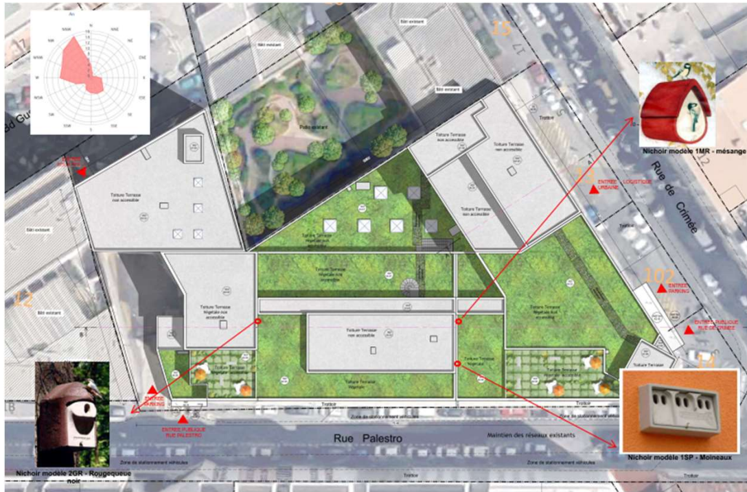
Localisation des nichoirs à oiseaux qui vont être installés sur les différentes façades, en tenant compte des expositions (notamment la protection contre le vent) Mise en place d'hôtels à insectes (à l'abri des vents et des pluies)
