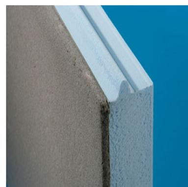
Isolation périphérique verticale - 60 à 80 cm + 15 cm au dessus TN pour lutter contre les ponts thermiques  $\Rightarrow$  de la hauteur de dalle à + 15 cm au dessus du TN = panneaux isolants PU finition béton du type roofmate ( $\lambda$  0.029)
