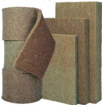
**métisse** ( $\lambda$  0.039) et densité 30 kg/m<sup>3</sup> déphasage 6 à 8 h et 4.87 en 190 mm (36€/m<sup>2</sup>) + ITE fibre de bois énergie + 40 / R=1.02 soit pour 230 mm R=5.89
