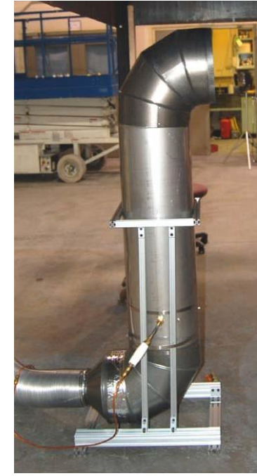
Le générateur de brandons avec sa matière première (bois déchiqueté).
