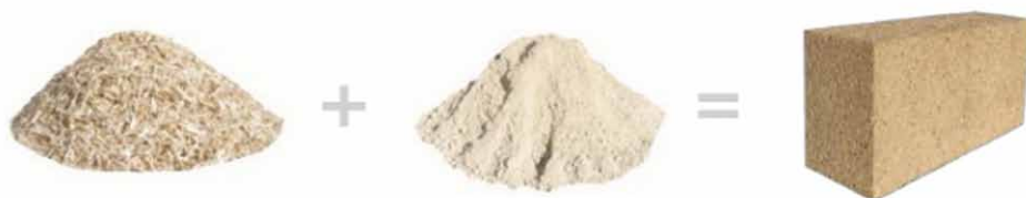
Chènevotte et chaux hydraulique pour la création de Chanvribloc
